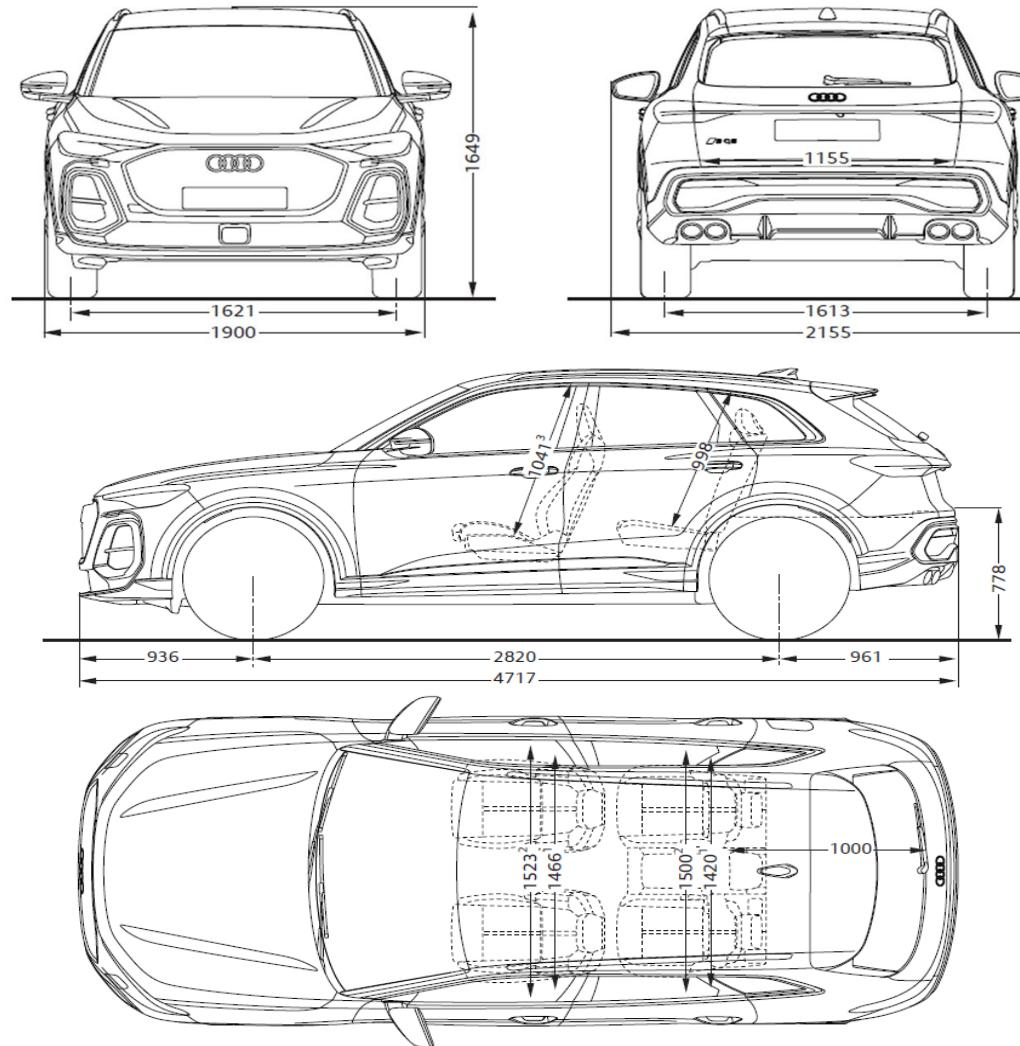
**Misure in millimetri** (indicazione delle dimensioni con<sup>1</sup> massa a vuoto)
